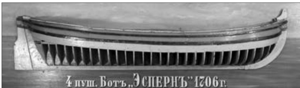
Ил. 12. Корабельный палубный бот середины XVIII в. Полумодель. 1740 г. (?) (ЦВММ. КП-669 инв. № 06 М-645)
