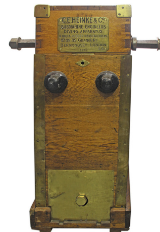
Водолазная ручная двухцилиндровая помпа простого действия Фирма «С. E. Heinke & Co submarine engineers diving apparatus & India rubber manufacturers. London». 1880-е
