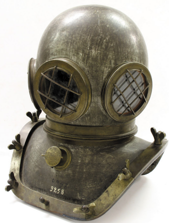
Шлем двенадцатиболтового вентилируемого водолазного снаряжения системы Ч. Э. Гейнке (С. E. Heinke) Адмиралтейский Ижорский завод 1861
