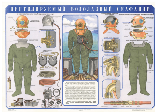
Плакат «Вентилируемый водолазный скафандр» ВОЕНИЗДАТ МО СССР, Москва. 1954
