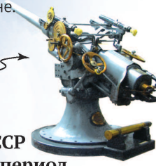
Корабельная пушка калибра 75 мм системы Канэ
