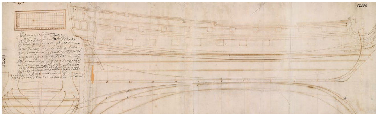
Вильям Гардинер (подмастерье). Чертеж теоретический 50-пушечного корабля с резолюцией Петра I. 1709 г.
